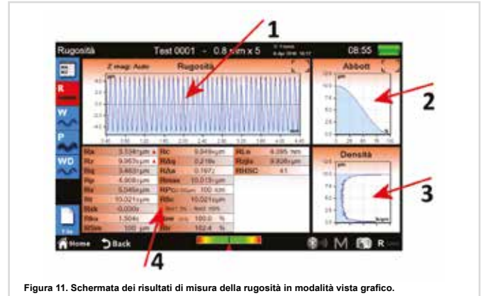
Figura 11. Schermata dei risultati di misura della rugosità in modalità vista grafico.
