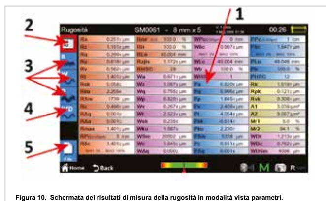
Figura 10. Schermata dei risultati di misura della rugosità in modalità vista parametri.
