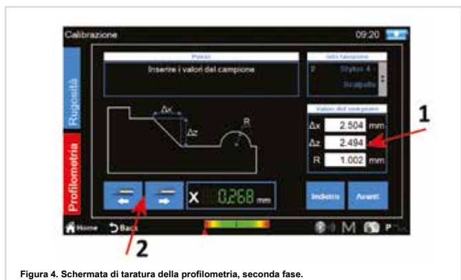
Figura 4. Schermata di taratura della profilometria, seconda fase.
