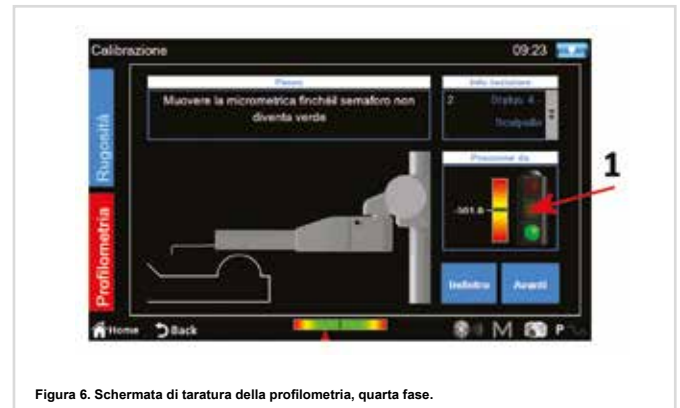
Figura 6. Schermata di taratura della profilometria, quarta fase.
