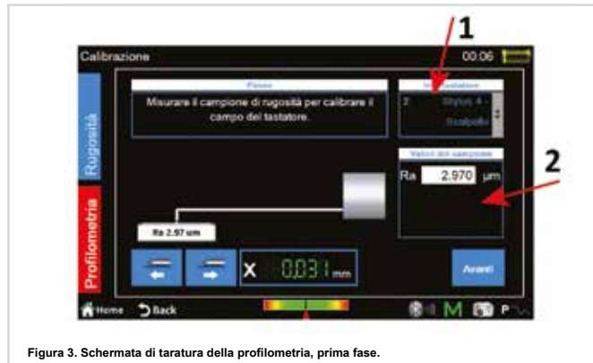
Figura 3. Schermata di taratura della profilometria, prima fase.
