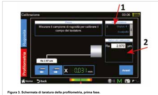
Figura 3. Schermata di taratura della profilometria, prima fase.
