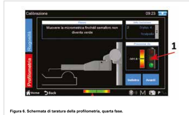
Figura 6. Schermata di taratura della profilometria, quarta fase.
