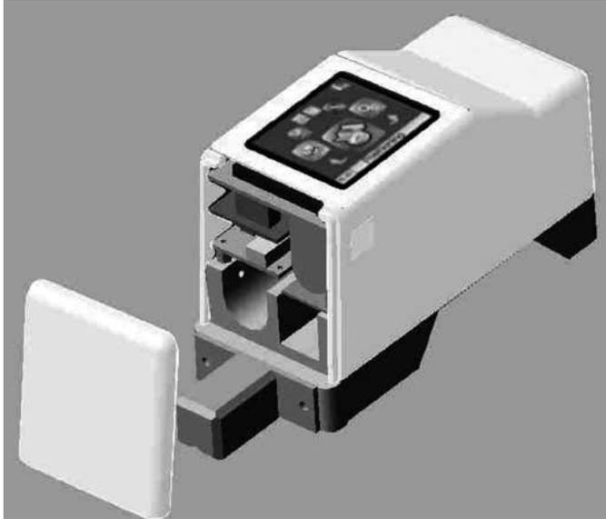
Figura 10. Vano dell'accumulatore aperto
